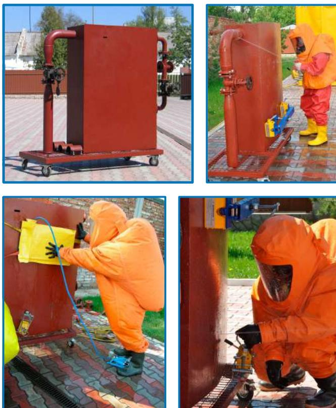
В состав тренажера входит имитатор емкости, выполненный в виде участка ее цилиндрической поверхности с системой трубопроводов, фланцевых соединений и запорной арматурой.
