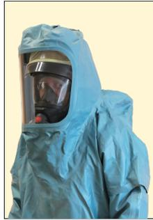
В комплект костюма входит специальный жилет-накидка, который надевается поверх дыхательного аппарата и предназначен для защиты его от воздействия жидкой фазы опасных химических веществ. Жилет-накидка имеет капюшон со вклеенным панорамным стеклом и рюкзак для размещения баллонов ДАСВ.
